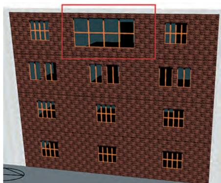
Figg. 4 (a sx), 5 (a dx) - Analisi parametriche sulla superficie finestrata di un'aula all'ultimo piano: variazione del rapporto tra superficie vetrata e superficie calpestabile da 1/8 a 1/3.
